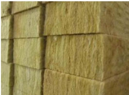
Теплоизоляционные маты укладываются в один, а лучше в несколько слоев. При устройстве теплоизоляции в несколько слоев швы плит необходимо устраивать в шахматном порядке. Толщина слоя для разных утеплителей может быть необходима разная. Главное запомнить – чем меньше коэффициент теплопроводности материала, тем он более способен удерживать тепло, и тем тоньше можно брать его слой. Значение коэффициента теплопроводности
